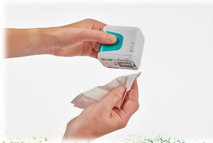
Fig. 18: Nettoyage de la tête d'impression
